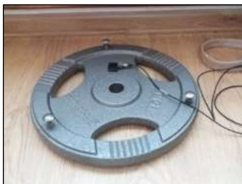
Obr. 3 Umístění snímače
